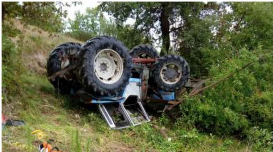
Esempio di schiacciamento della cabina non ROPS (cosiddetta cabina meteorica)
