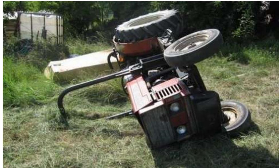
Efficacia della struttura di protezione nell'arrestare il capovolgimento a 90° (rovesciamento laterale)
